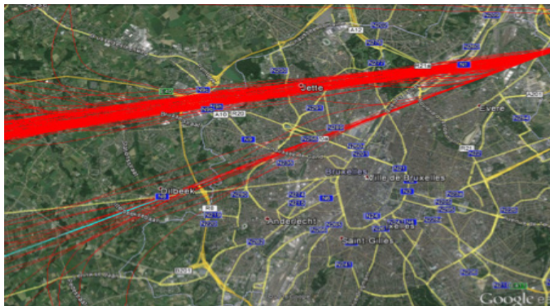
Vergelijking tussen de radarplots in VOR-modus (gebogen benadering) en RNP-modus (continue daling)
